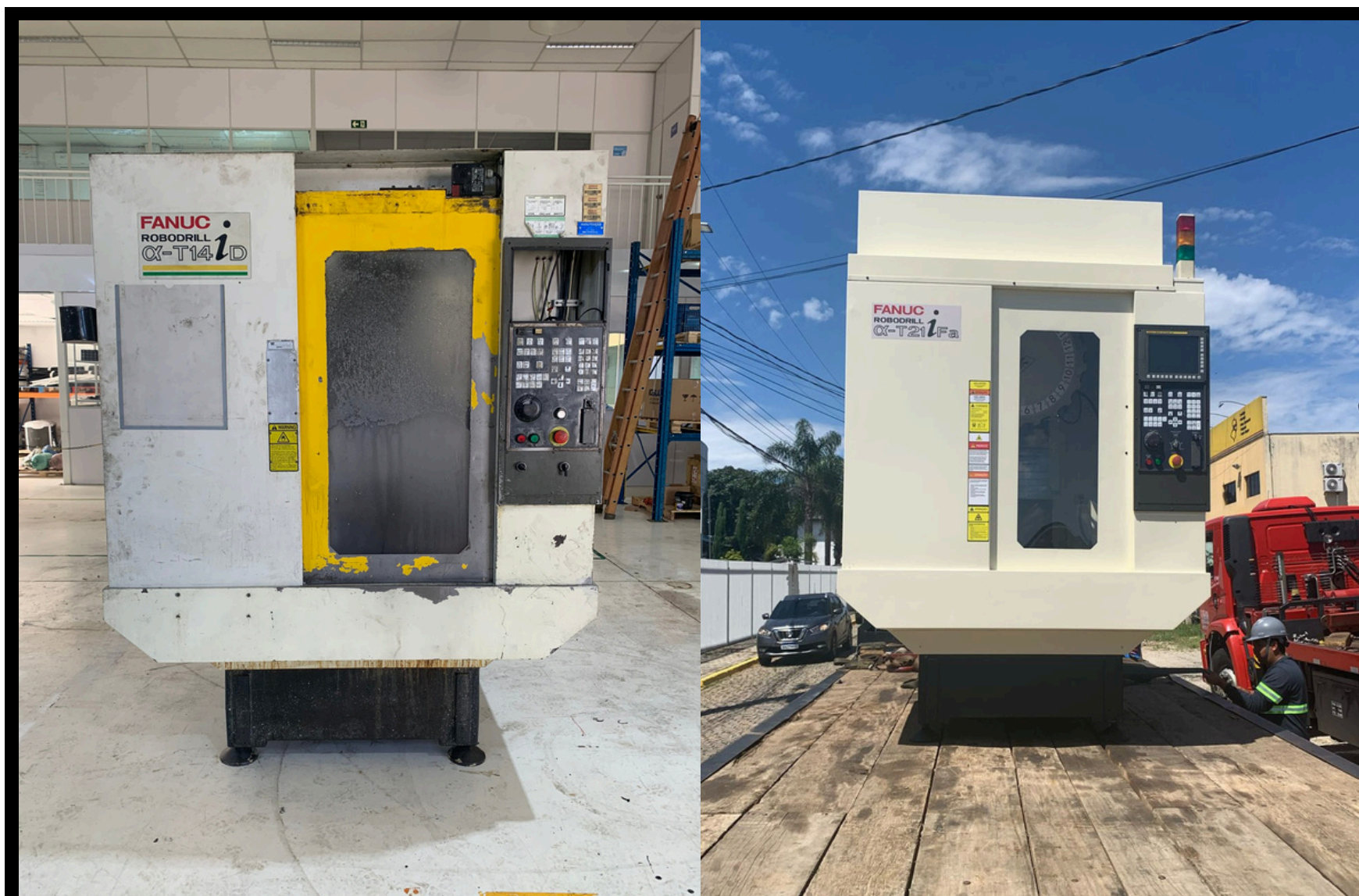
Retrofitting de Centro de Usinagem FANUC Robodrill realizado pela Bvex Máquinas e Equipamentos.
